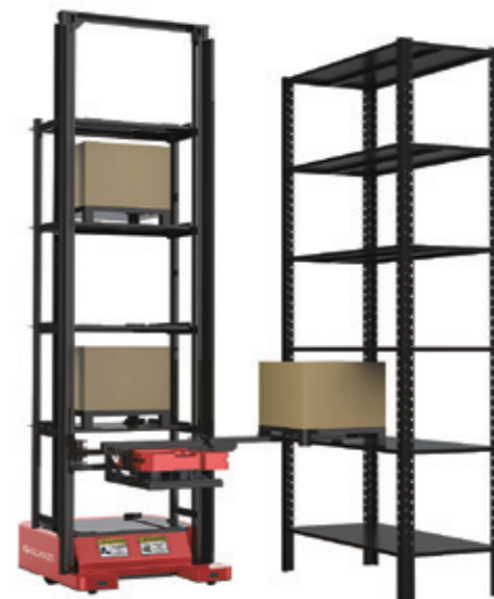
「STAR SYSTEM」用無人搬送車。写真左は荷棚からロボットがパレットを取り出しているところ。出荷頻度の高い商品は、写真下のような大型搬送車で大きなパレットごと運ぶ
