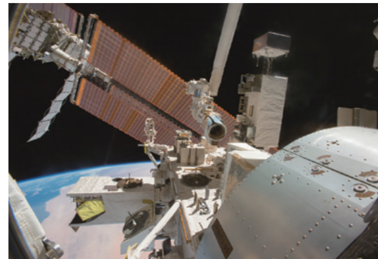
「きぼう」船内から見たロボットアーム。「きぼう」だけが持つ同アームを使用して超小型衛星を宇宙空間に放出する(写真提供: JAXA/NASA)
